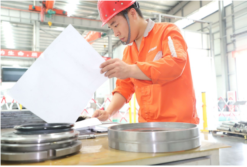
德通振动搅拌公司质检员正在测量精加工的法兰
